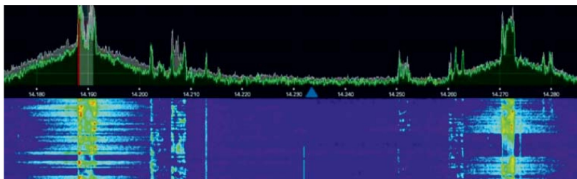
Εικόνα 1. Πάνω: Τα εσωτερικά noise blankers των πομποδεκτών προκαλούν παραμόρφωση με ισχυρά σήματα. Με το NR-1, δεν παρατηρείται παραμόρφωση με ισχυρά σήματα (κάτω).
